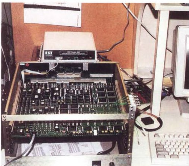
Una foto della scheda Video Generator, «rubata» durante una sessione di prove hardware nei laboratori della Loral.
